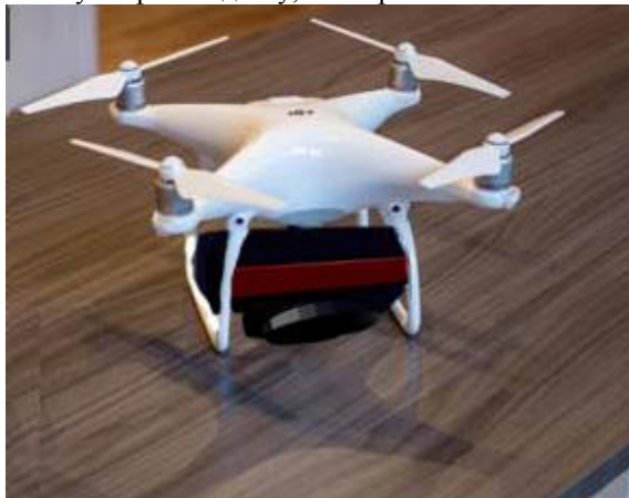
Рис. 1 - БПЛА для обработки вегетирующих растений
