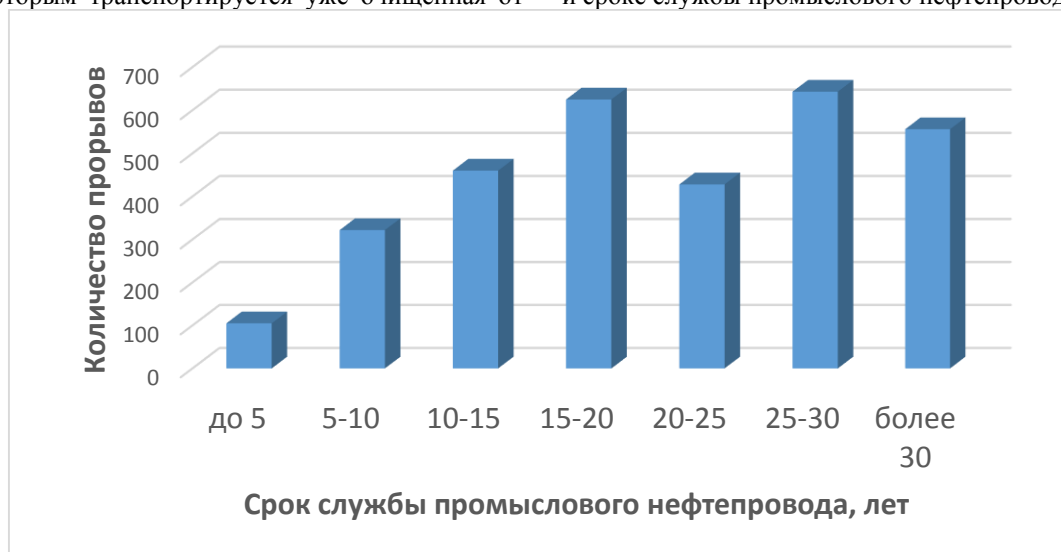
Рис. 1.2 – Количество прорывов в зависимости от срока службы промыслового нефтепровода
