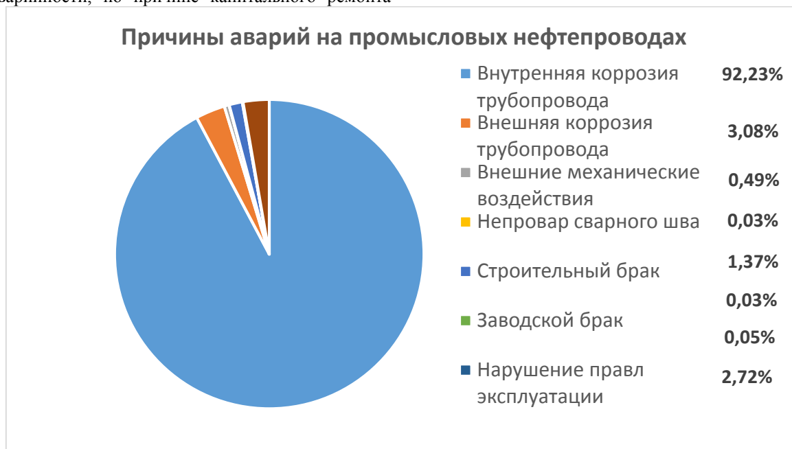
Рис. 1.3 – Причины возникновения аварий на промысловых нефтепроводах
